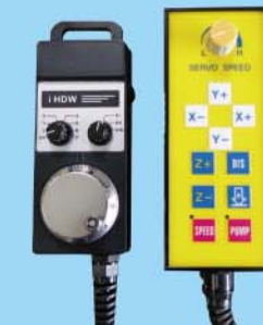
■ 人性化，電子手輪配合線控盒，校模精準快速，最小移動單位0.001mm。
